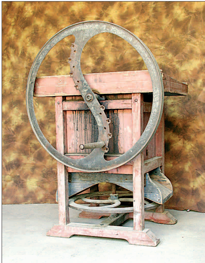
66-68. Sgranatrici per granturco azionabili a mano: la prima dell'Ottocento, la seconda dei primi del Novecento e infine l'ultima della metà del Novecento.
